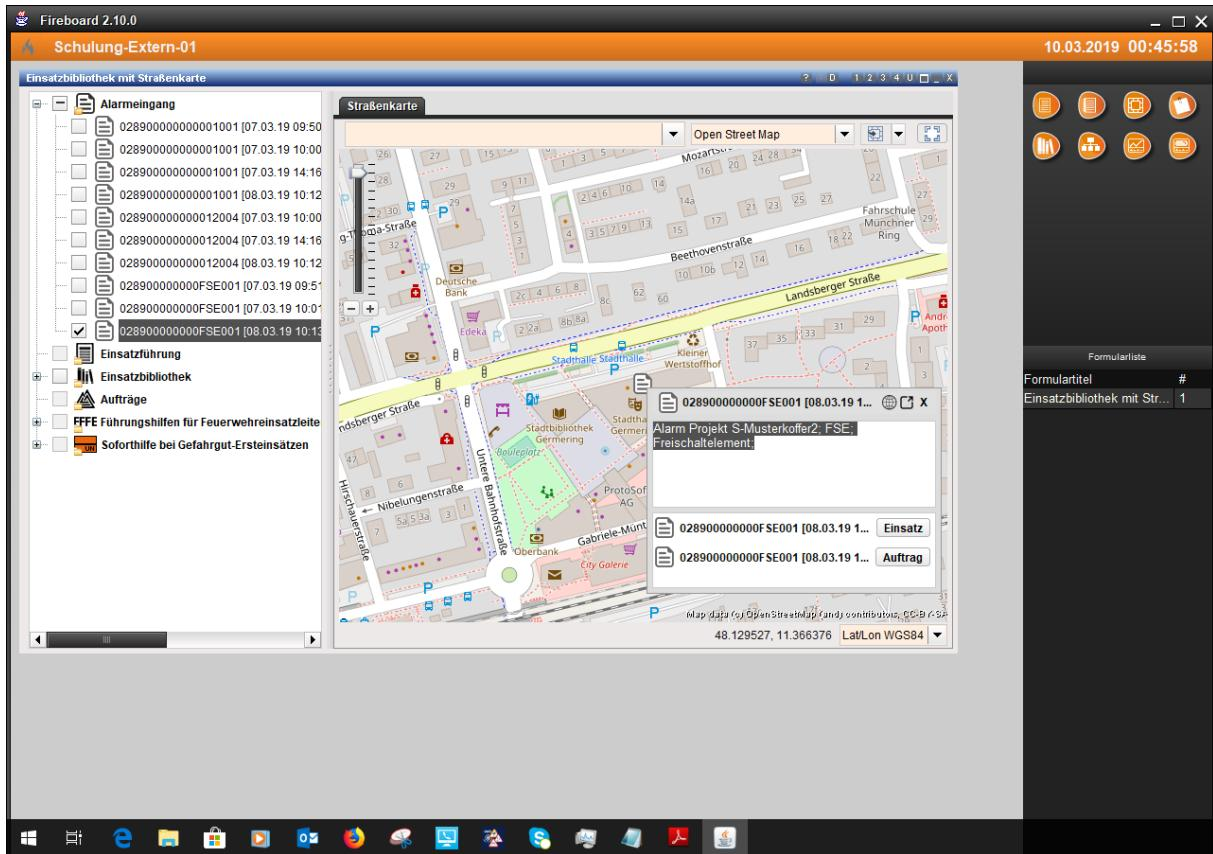
Der Text: „Alarm Projekt S-Musterkoffer2; FSE; Freischaltelement;“ kommt aus der BMA und kann dort hinterlegen, bzw. zugeordneten Text enthalten, wie z.B. die Meldernr., Meldergruppe, Art des Melders, wichtige Hinweise usw.
